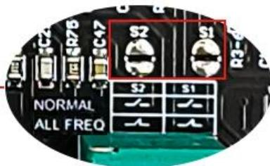
出厂默认非短接，为正常模式，立体声输出不含200Hz以下低音部分。
